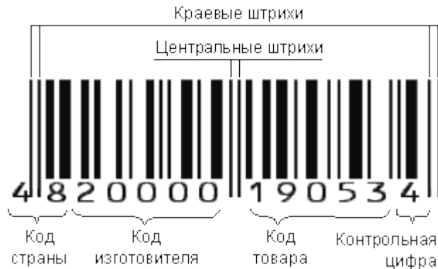
Рис.2. Структура штрихового коду EAN-13
